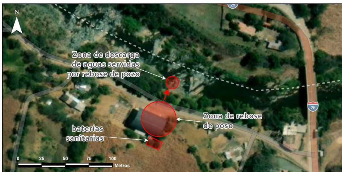
Figura 11: Contaminación por aguas servidas Quillusara
